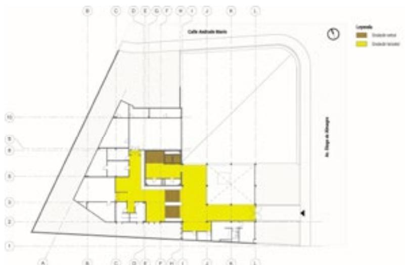
Ilustración 10 Plano mostrando circulaciones generales en planta baja. Elaboración propia
