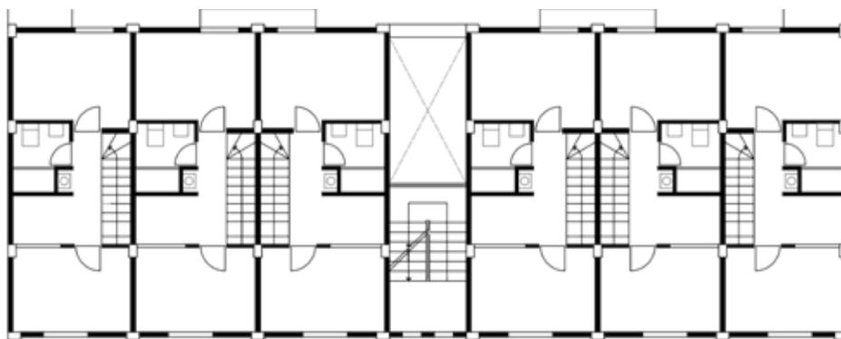
Ciudad Bicentenario. Tipología dúplex sobre dúplex Planta Primera. Dibujo: Carranza M. y Mueses J.
